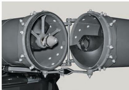
Выгрузной шнек вращается с низкой частотой, но имеет большой диаметр и, как следствие, высокую производительность. При таком подходе качество зерна остается высоким!
