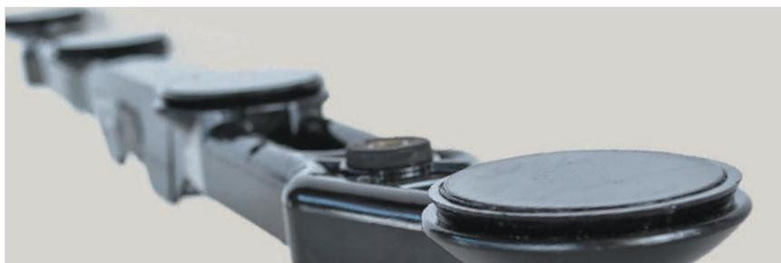
Датчики потерь в конце решетного стана помогают оператору регулировать рабочие параметры машины: они регистрируют падение материала на землю по давлению и акустическим волнам.
