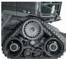
Гусеничная ходовая часть TrakRide обеспечивает исключительно низкое давление на грунт.
