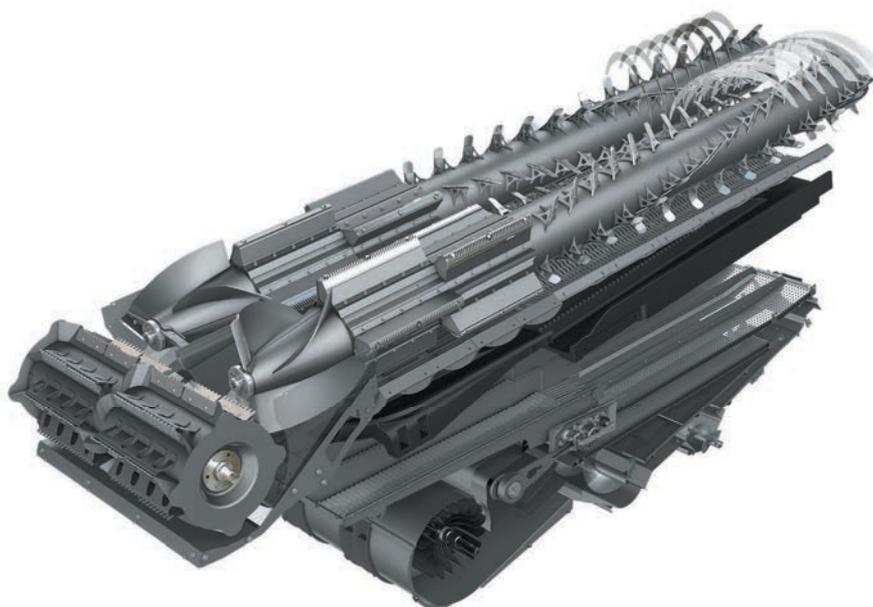
Молотилка Single Helix с одним ротором (модель IDEAL 7) и молотилка Dual Helix с двумя роторами (модели IDEAL 8 и 9) обеспечивают высочайшую производительность при щадящей обработке материала.
