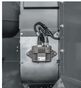
Остановок для выгрузки зерна требуется меньше и они длятся меньше, что незамедлительно сказывается на повышении ежедневной производительности. На наклонной камере установлены датчики урожайности и влажности, а также камера контроля качества зерна. Точность данных достигает 98 %. Информация поступает в систему VarioDoc, использующую стандарт ISOBUS. На ее основе осуществляется картирование урожайности в режиме реального времени, а также устанавливаются настройки системы IDEALharvest™.
