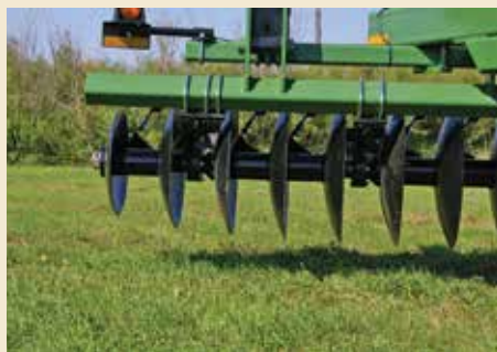
Офсетная дисковая борона Вишек 812N-OCL имеет диски размером 711 мм на расстоянии 279 мм. В моделях с крыльями имеется система блокировки OCL (Over Center Lock) для полного выравнивания. Данная система предотвращает подъем крыльев с грунта закрепляя их в неподвижном состоянии на основной раме.
