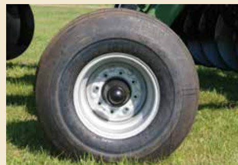
Стандартные шины на дисковые модели Вишек: • Модель 612N: шины 11L x 15 • Модели 812N, 842N, & 862N: 12.5L x 15 • Модель 932N: грузовые шины 6/у 385/65R 22.5
