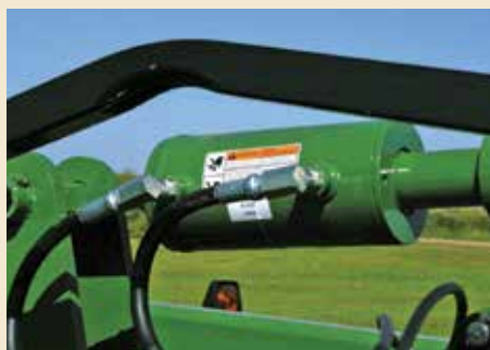
Регулируемая система выравнивания, входящая в базовую комплектацию, выравнивает агрегат по всей длине. Дополнительная опция - гидравлическая система выравнивания.
