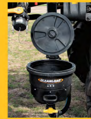
ЭЖЕКТОР ДЛЯ ЗАПРАВКИ АГРОХИМИКАТОВ Через специальный трубопровод смешанный продукт подается в нижнюю часть основной емкости, что уменьшает пенообразование.
