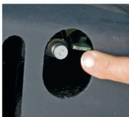
□ Сбоку машины предусмотрен штуцер для удобной регулировки натяжения гусеничных лент.
