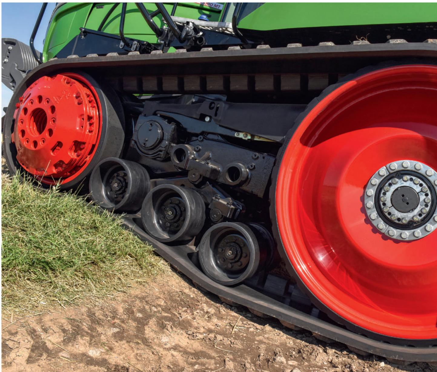
Опорные катки на подвеске прижимаются к поверхности и точно повторяют ее контур. При этом площадь пятна контакта с поверхностью всегда является максимально возможной, а тяговое усилие передается непрерывно.
