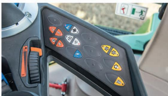
Мембранные клавиши на подлокотнике для настройки параметров работы коробки передач, гидравлической системы и VOM.
