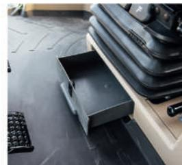
■ Отсек для хранения под сиденьем оператора. Он позволяет поддерживать порядок в кабине.
