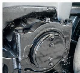
□ Система регулировки ширины колеи делает трактор Fendt 900 Vario MT пригодным для работы с различными культурами.
