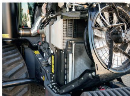
Оптимальная температура воздуха на впуске в цилиндры поддерживается большим промежуточным охладителем наддувочного воздуха.
