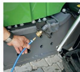
□ В переднюю часть машины вынесли штуцер пневматической системы для очистки радиатора сжатым воздухом.
