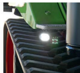
□ Светодиодные световые приборы отлично освещают пространство перед машиной.
