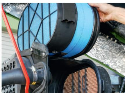
Легко заменяемый воздушный фильтр дополнен датчиком степени загрязненности.
