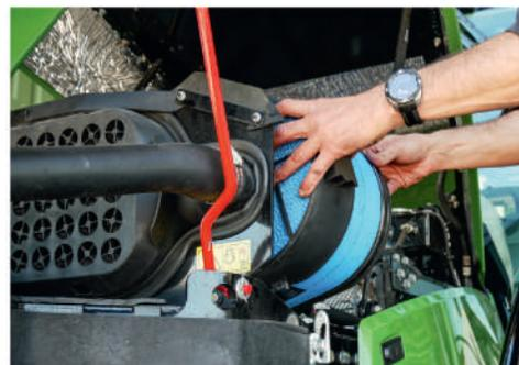
Большой цельный капот упрощает техническое обслуживание в моторном отсеке. Воздушный фильтр удобно обслуживать с подножки.
